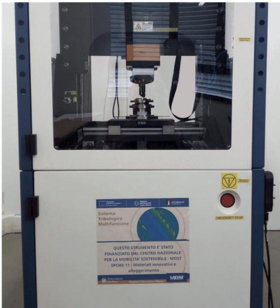
TRIBOMETRO MULTIFUNZIONALE per prove di attrito e usura
