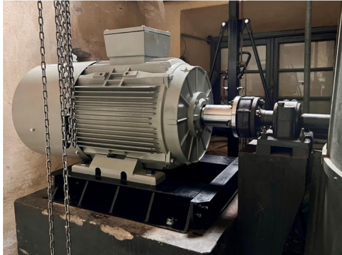
MOTORE ELETTRICO (37 kW IE3, 6 poli) per Galleria del Vento
